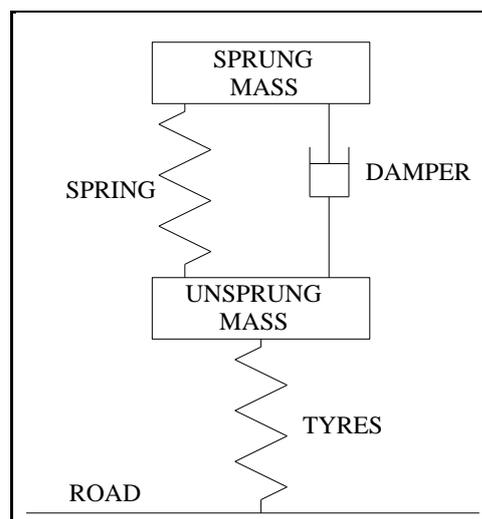
FIGURE 12: MOTOR VEHICLE SPRUNG/UNSPRUNG MASS
