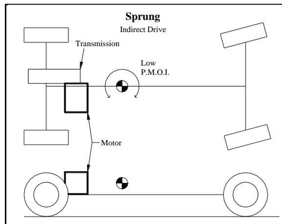
FIGURE 14: SPRUNG MOTOR PMOI AND COG
