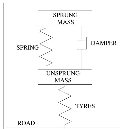
FIGURE 6: ONE D.O.F. MOTOR VEHICLE SPRUNG/UNSPRUNG MASS
