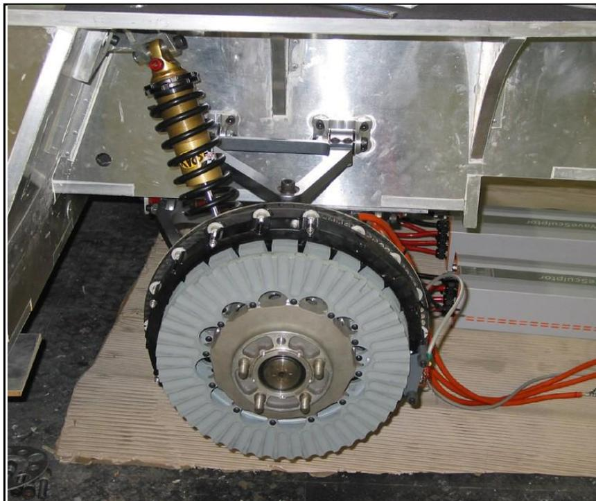
FIGURE 37: WHEEL MOTOR (HYBRIDAUTO.PTY.LTD, 2006)
