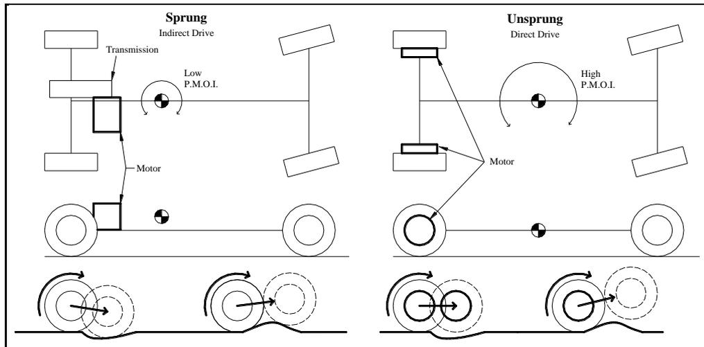
FIGURE 16: FBD SPRUNG UNSPRUNG MOTOR LOCATIONS
