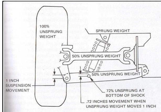
FIGURE 13: SPRUNG AND UNSPRUNG % BY MOTION (PUHN, 1981)
