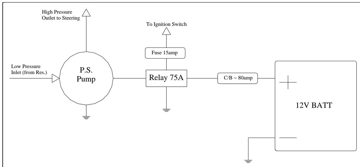
FIGURE 30: POWER STEERING-ELECTRICAL CIRCUIT
