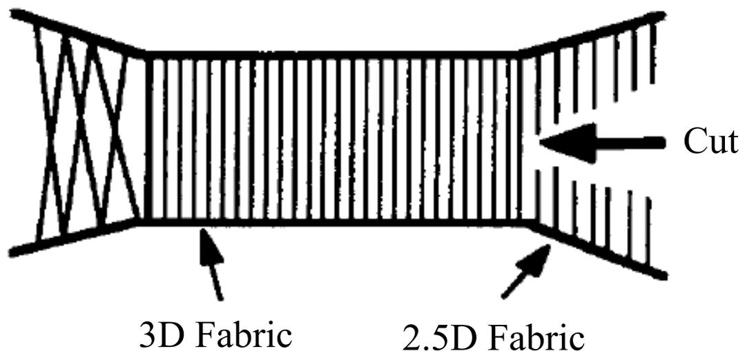
**Figure 4:** Fabrication of 2.5D fabric (Sohn & Hu 1998)
