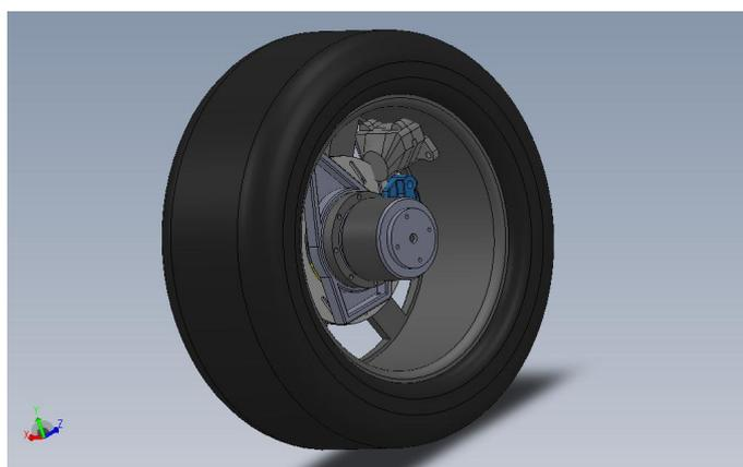
**Figure 6.10:** Draft Unsprung Setup
